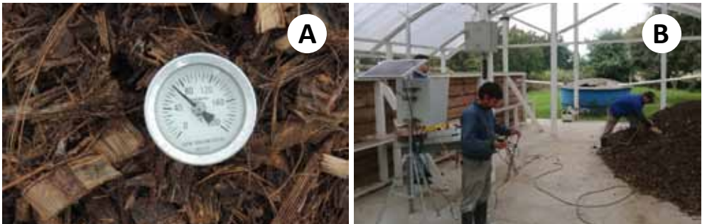
Figura 8. Monitoramento da temperatura nas pilhas de compostagem com termômetro convencional (A) e por datalogger (B)
