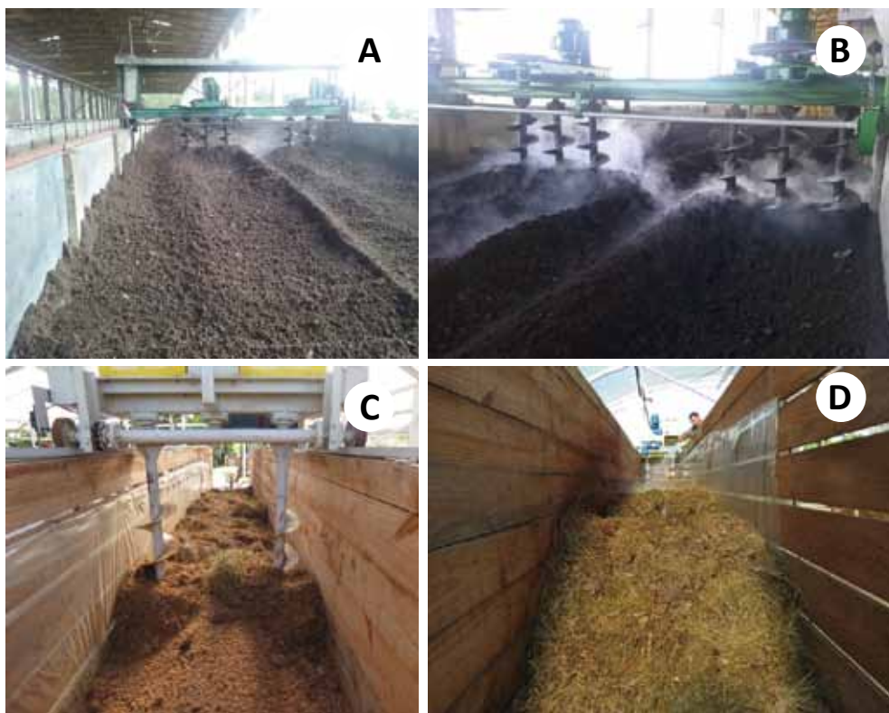
Figura 5. Sistema de compostagem automatizada de resíduos do abate e criação de suínos (A e B); de resíduos de poda de jardins misturado a grãos residuais de soja (C e D)
