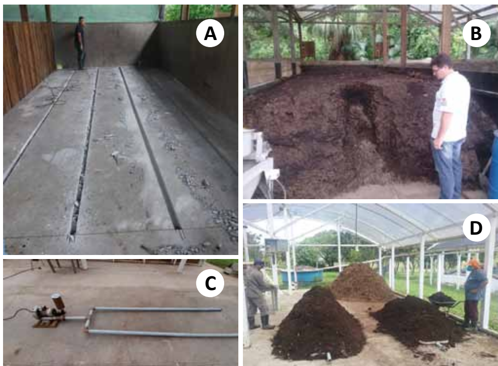
Figura 2. Sistemas de aeração de compostagem com uso de canaletas com canos inseridos no piso (A e B) e com compressor radial acoplado a canos perfurados inseridos sob a pilha de compostagem (C e D)
